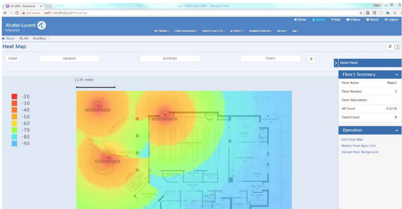
Малюнок 3. Теплова карта для оптимізації покриття Wi-Fi та продуктивності бездротової мережі
